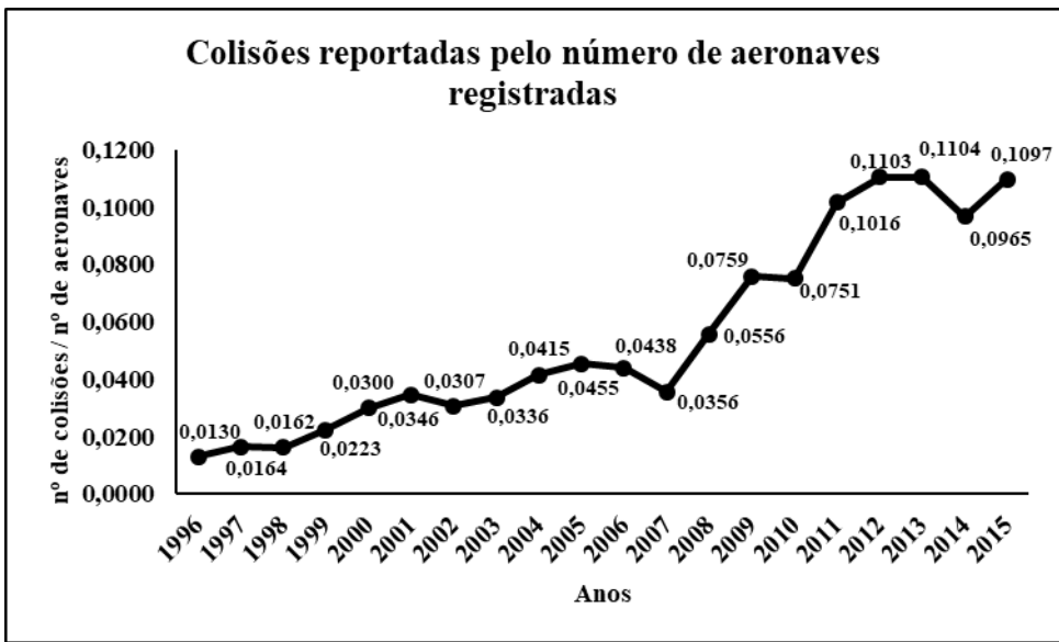
Figura 3: Relação do número de colisões reportadas pelo número de aeronaves registradas entre os anos de 1996 e 2015.
